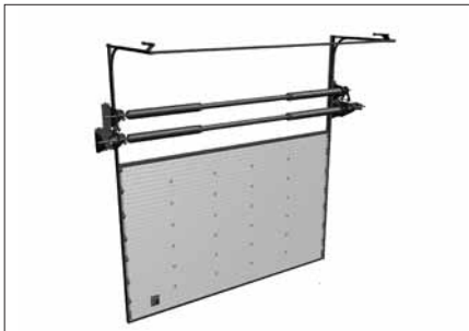
Высокий подъём, с выносным валом, двухвальная система
